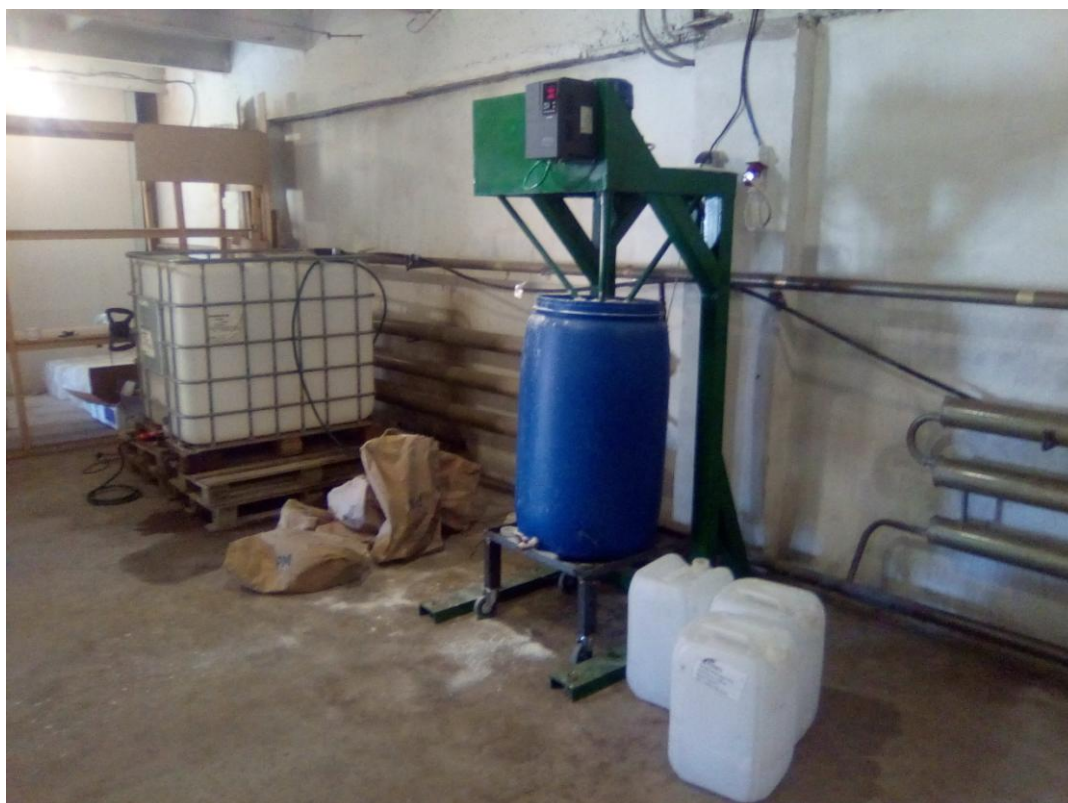
Рисунок 4. Диссоolver на партию продукции 300кг (на нём Вы производите краски, бетоноконтакт, шпатлевки, клея и др.)
